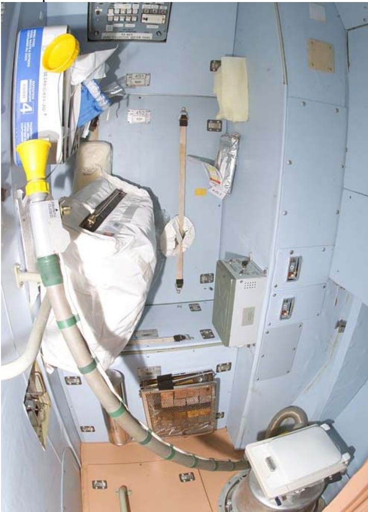
Imagen: El inodoro ruso de la ISS, durante muchos años el único que ha existido a bordo de la estación. El tubo con el embudo amarillo es el dispositivo para la recogida de orina. (Foto: NASA)
