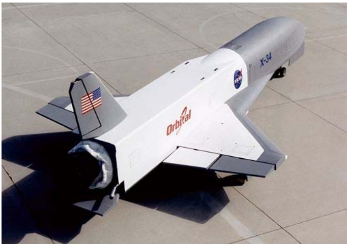
Imagen: El X-34 se basaba también en el concepto SSTO para desarrollar un vehículo de transporte de tripulaciones a la órbita terrestre totalmente reutilizable. (Foto: NASA)
