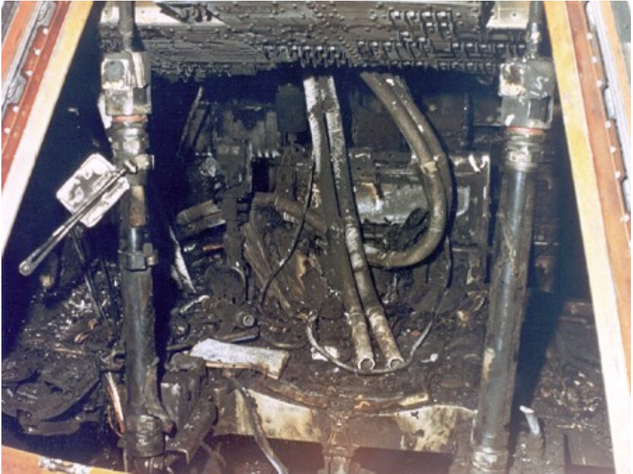
Imagen: Interior de la cápsula del Apollo 1 tras el incendio. ( Foto: NASA )
