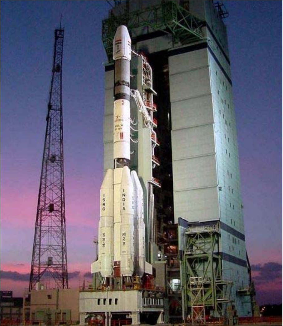
Imagen: Lanzador GSLV, el mayor en la actualidad de la flota de lanzadores indios. (Foto: ISRO)
