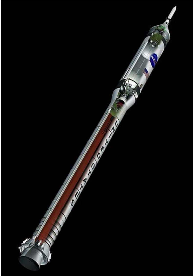
Imagen: El lanzador del CEV será probablemente un derivado de los aceleradores sólidos del transbordador espacial, al que se le añadirá una etapa superior de propulsante líquido. (Imagen: Alliant Techsystems Inc.)
