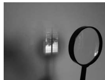
Imagen creada por una lente convergente sobre una pared. Fijaos que la imagen está invertida.
