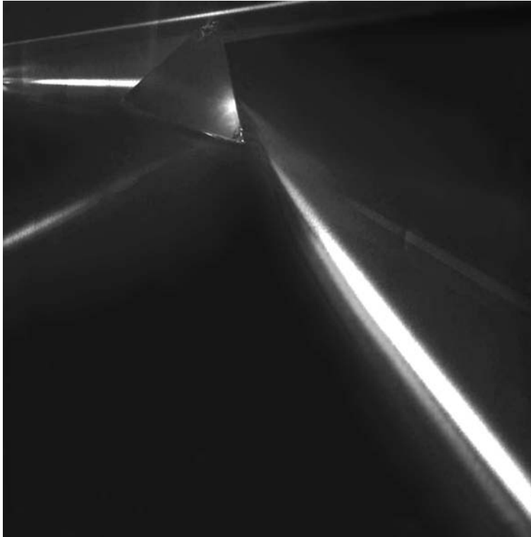
Figura 12. Dispersión de la luz de una lámpara de mercurio en un prisma de vidrio flint
